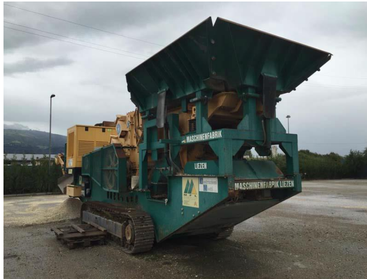
Слика бр. 2.3.2.1: Изглед мобилног дробиличног постројења MFL -100Топ
